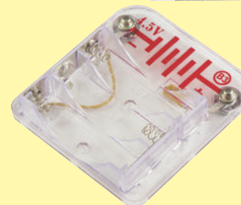
Miejsce na baterie (B3)
